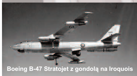
Gondola z silnikiem Iroquois na B-47 przemianowanym na CL-52
